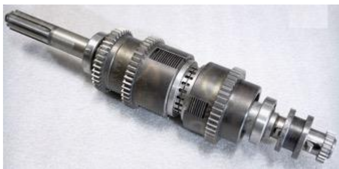
Сурет 1.12 - Токарлық-бұранда кесу станогының фрикциялық муфтасы
