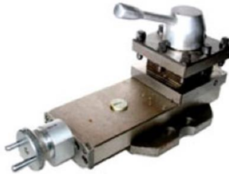
Сурет 1.9 - Токарлық-бұранда кесу станогының суппорты
